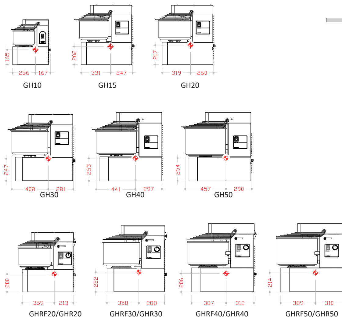
Fig. 3.9.2. - Centre de gravité de la machine
